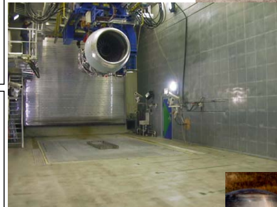
Austrittskegel von BR700 Triebwerken in denen neuartige Absorber getestet werden
