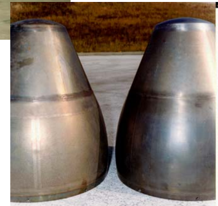
Austrittskegel von BR700 Triebwerken in denen neuartige Absorber getestet werden
