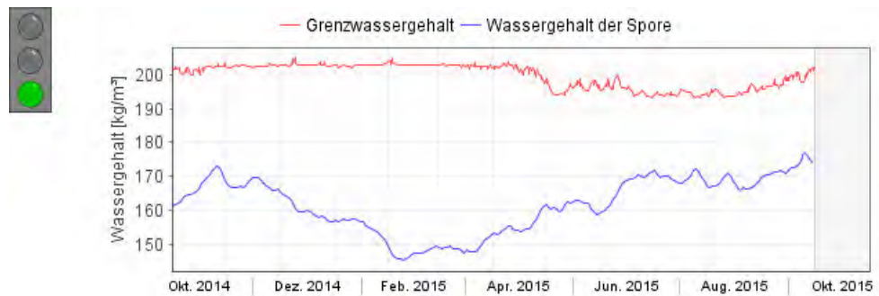
Abb. 43: Einer Spore zur Verfügung stehender Wassergehalt an der Innenoberfläche der Außenwand im Schlafzimmer Obergeschoss; nach Teilsanierung ohne mechanische Lüftung; Berechnet mit WUFI Bio [w27]. Der kritische Grenzwassergehalt für die Substratklasse I (gut verwertbare Substrate, wie z.B. Gipskarton) über dem biologische Aktivität einsetzt wird nicht überschritten.
