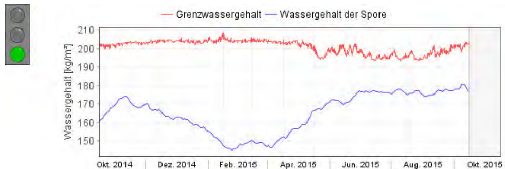
Abb. 44: Einer Spore zur Verfügung stehender Wassergehalt an der Innenoberfläche der Außenwand im Badezimmer im Obergeschoss nach Teilsanierung ohne mechanische Lüftung; Berechnet mit WUFI Bio [w27]. Der kritische Grenzwassergehalt für die Substratklasse I (gut
